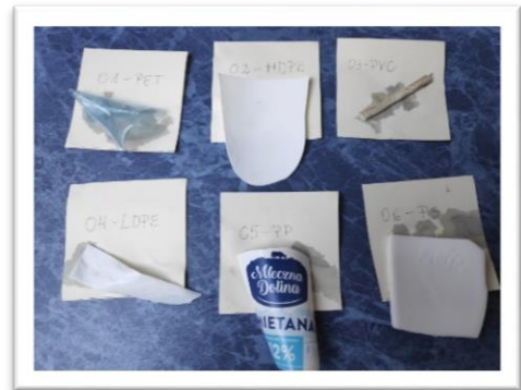
Próbki tworzyw sztucznych po wyjęciu z wrzącej wody
